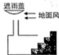
D. 地下通道的自动抽气设计
