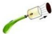
A. 电火花发生器点火后将盒盖顶出
